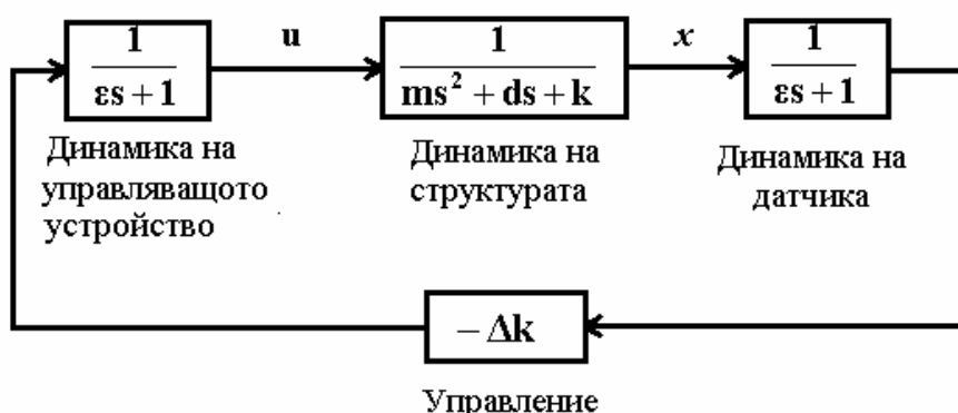
Фигура 1.4. Активно управление m\ddot{x} + d\dot{x} + kx = u
