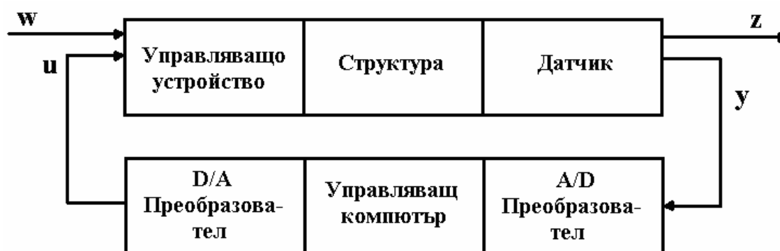
Фигура 1.3. Схема на задачата за структурно управление
